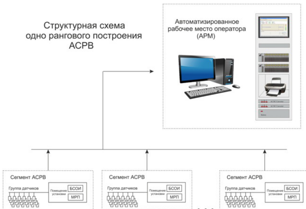
Мал. 2 Структурна схема побудови АСРВ як об'єднання однорангових сегментів.
